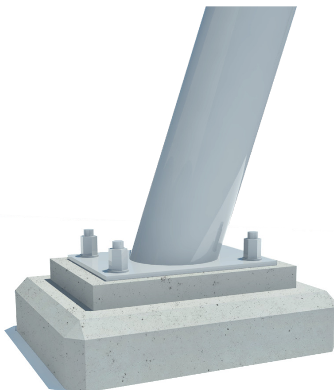
DETAL B - ŁĄCZENIE SŁUPA Z FUNDAMENTEM
