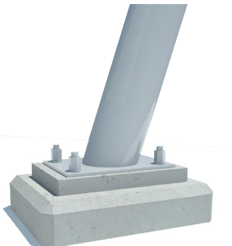
DETAL B - ŁĄCZENIE SŁUPA Z FUNDAMENTEM
